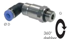
\* Diese Anschlüsse nur mit Luft verwenden. Sie sind weder geeignet für die Verwendung mit Wasser oder anderen Flüssigkeiten noch mit anderen Gasen außer Luft. Die Anschlussstücke sind mit einem Schlüssel am Sechskant des Zapfens anzuziehen. Betriebsdruck: max. 10 bar, sowie Grobvakuum, Temperaturbereich: 0°C bis max. +60°C
