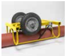
Rohr mit Ratschengurt an dem umgedrehten Wagen befestigen
