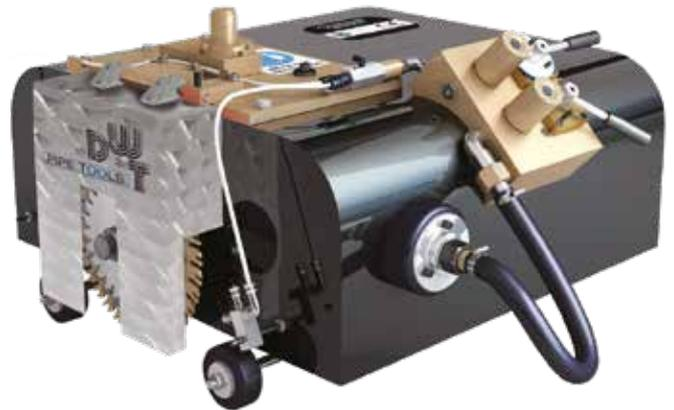
Der hochbelastbare Kettenspannmechanismus in einem hochfesten Aluminiumrahmen bietet die notwendige Steifigkeit und Festigkeit, um das Rohr mit der höchstmöglichen Geschwindigkeit zu schneiden. Der Rahmen der Maschine hat sechs Radpositionen, um dem Radius des Rohres besser zu folgen und Spurverfolgungsungenauigkeiten zu minimieren.
