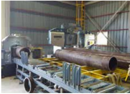
Rohre trennen und anfasen
