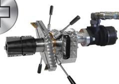
Maschine mit Hydraulikmotor
