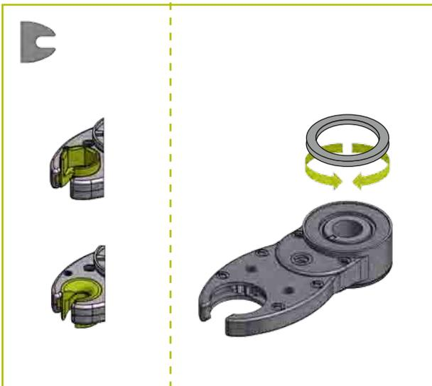
Je nach gewünschter Abtriebsdrehrichtung (rechts- oder links-drehend) und Einbaurichtung (oben oder unten abtreibend) des Abtriebszahnades, muss die zu sperrende Drehrichtung eingestellt werden. Grundsätzlich können alle Abtriebszahnäder in beiden Drehrichtungen betrieben werden.
