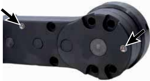
Abb. 9: Position der Schmiernippel am Beispiel eines geschlossenen Flachabtriebs
