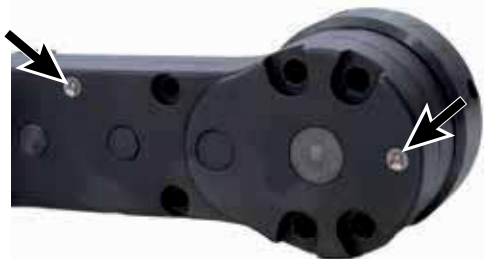
Abb. 9: Position der Schmiernippel am Beispiel eines geschlossenen Flachabtriebs
