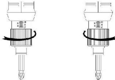
Den Drehmomentwert des Elektroschrauber kann man durch ändern der Federspannung verändern, d.h. Ein- oder Aufschrauben der Kappe (Pos. 3). Um das Drehmoment zu erhöhen, drehen Sie die Kappe im Uhrzeigersinn, um es zu sinken, drehen Sie die Kappe gegen den Uhrzeigersinn.
