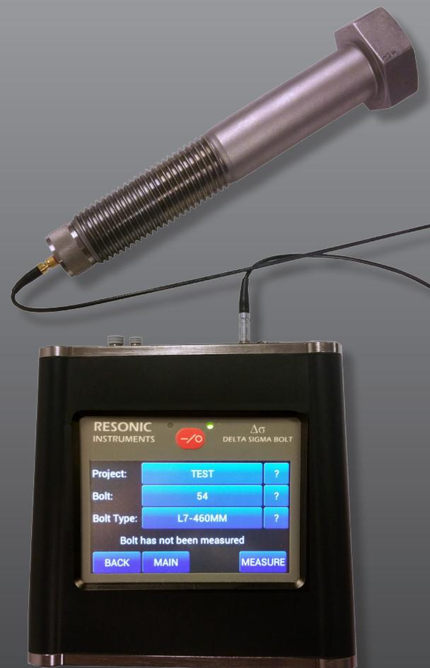
Das Ultraschall Messgerät, misst, zeigt an, speichert und überträgt Dehnungsdaten und Schraubenkraft. Das Messgerät besitzt einen robusten, versiegelten Farb-Touchscreen für eine optimale Bedienung. Der Bildschirm nutzt eine bewerte medizinische Touch-Panel-Hardware. Das Messsystem besteht aus einer Hybridtechnik, welche das Beste aus analoger und digitaler Signalverarbeitungstechnik für schnelle Signalerfassung und präzise Einzelschuss time of flight (TOF) Messungen.
