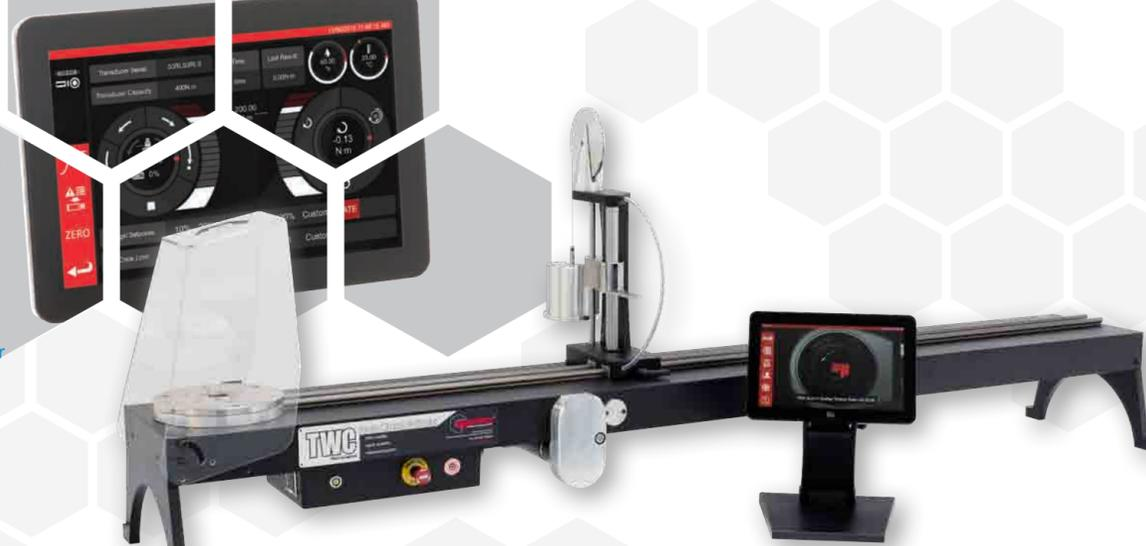
Das Gegengewichts-System ist so gestaltet, dass das Gewicht des Schlüssels unterstützt wird, so dass das Gewicht nicht zu einer parasitären Kraft im Kalibriersystem wird. Die schwebende Art und Weise des Systems bedeutet, dass der Schlüssel in der Lage ist, sein individuelles natürliches Niveau zu finden, anstatt wie bei vielen anderen Prüfvorrichtungen fixiert zu sein. Jede solche Fixierung wird eine parasitäre Kraft innerhalb des Systems verursachen. (Patentiert)
