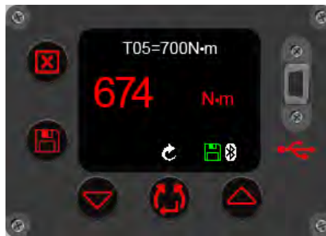
ABBILDUNG 52 – Sollergebnis Drehmoment (rot für misslungen dargestellt)
