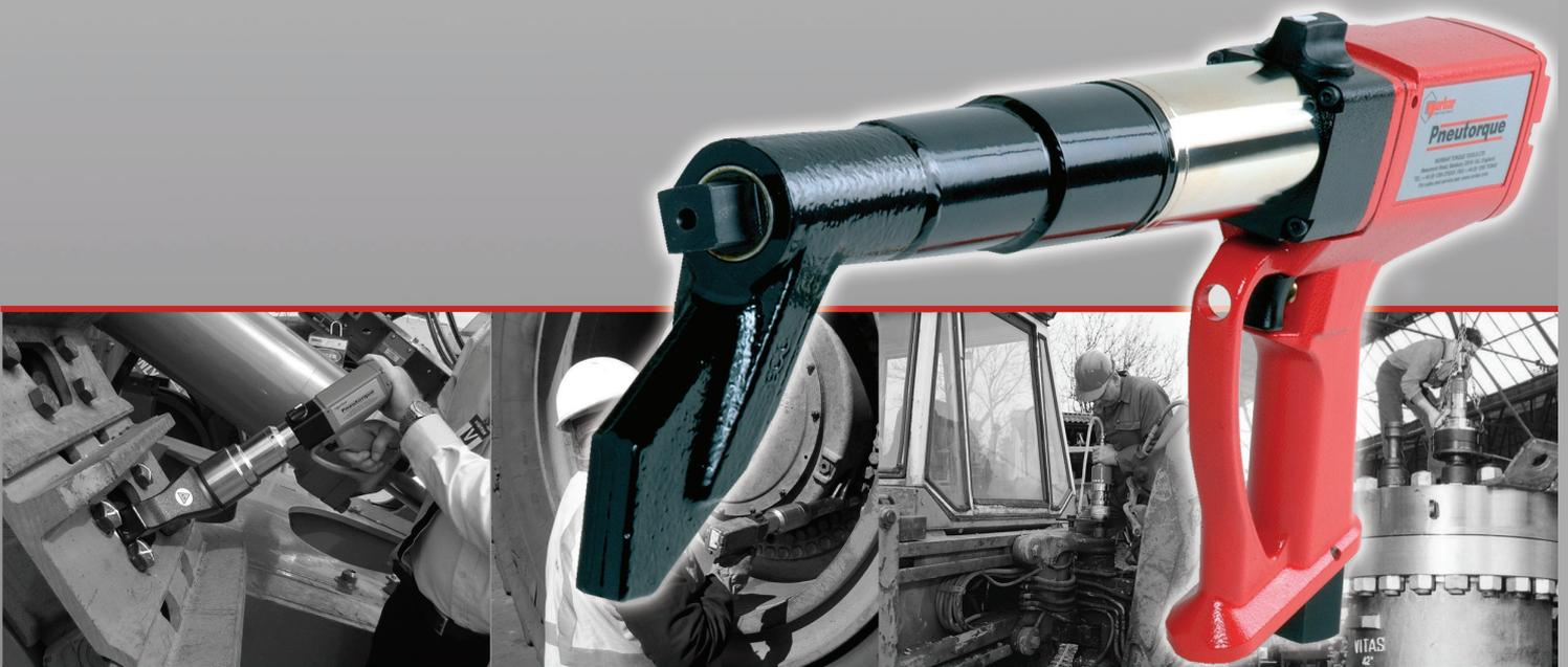
Die **Druckluft Kraftschrauber** von Norbar sind ideal für Montage- und Instandhaltungsarbeiten. Die Produktivität der Kraftschrauber wird durch zwei Motoren unterstützt, wobei ein Hochgeschwindigkeitsmotor dem schnellen Eindrehen dient und ein weiterer drehmomentstarker Motor für den drehmomentgenauen Endanzug sorgt. Durch die leichte und kompakte Bauweise sind die Druckluft Kraftschrauber besonders handlich.
