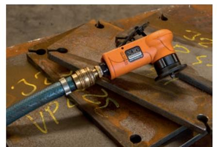
Die Maschine ist zum Entgraten und Abrunden von Kanten bei Teilen und Werkstücken aus Stahl, Edelstahl, Aluminium und weiteren Werkstoffen bestimmt. Sie eignet sich zum Bearbeiten von Bohrlöchern und Öffnungen ab einem Innendurchmesser von 6,8 mm.
