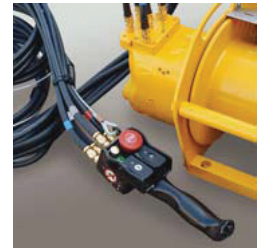
PHS Steuerung mit Not-Aus-Schalter
