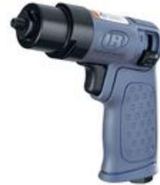
Neu: Mini-Poliermaschine 3129XPA Ingersoll Rand: Ideal für das Hochglanzpolieren von Lack-, Metall- und Kunststoffoberflächen; Mit einer freien Drehzahl von 6.400 1/min erbringt er dieselbe Leistung wie Poliermaschinen doppelter Größe; Beidseitig einstellbare, variable Drehzahl bietet mehr Flexibilität und eröffnet ein breiteres Anwendungsgebiet; einschließlich 3" (75mm) Stützteller mit Klettverschluss
