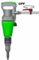
Vor und nach Gebrauch des Hammers, Luftzufuhr der Energiequelle absperren und dann erst Schlauch entfernen bzw. anschließen. Vor Inbetriebnahme, Hammer senkrecht stellen.
